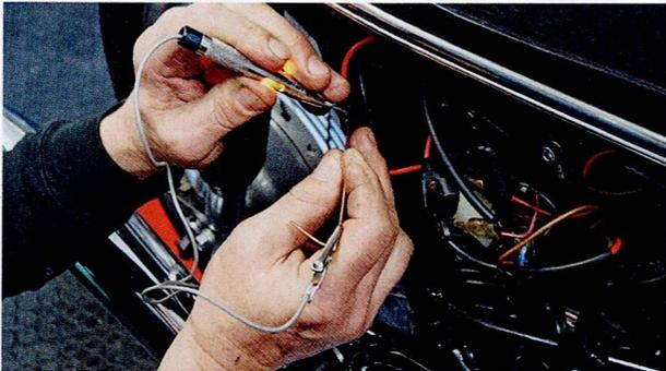
... und mit der Prüflampe der Stromfluss gemessen
