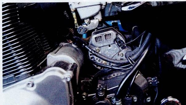
Bei der Suzuki Bandit ist die Lichtmaschine für Messungen leicht zugänglich
