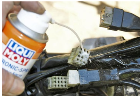
Mit KONTAKTSPRAY lassen sich Übergangswiderstände schnell und dauerhaft beseitigen
