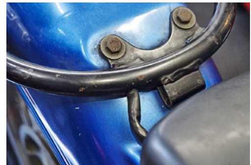
Hier kann der HECK-KABELSTRANG am Rahmenausstritt scheuern. Ein zusätzlicher Kantschutz schafft Abhilfe
