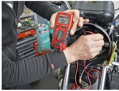
Mit der OHMMESSFUNKTION des Messgeräts lässt sich der Widerstand der Kabel und Stecker messen
