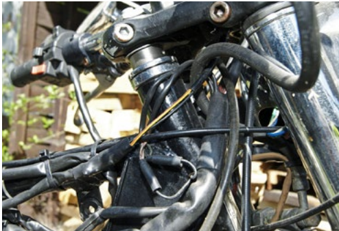
KABELAUSTRITTE AUS KABELTÜLLEN müssen genau geprüft werden. An den Kanten können die Kabel scheuern
