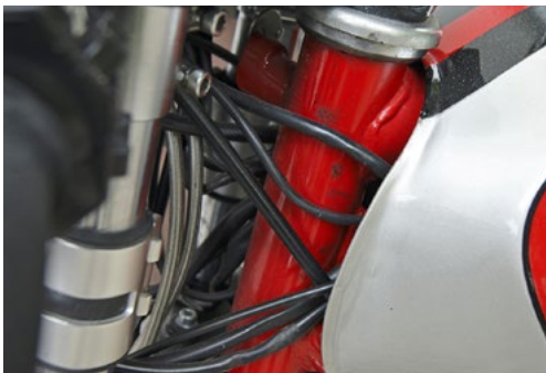
Auch an der TANKKANTE im Bereich des Lenkkopfs können Kabelisolationen schnell reißen oder durchscheuern
