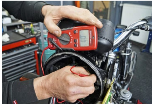
Wenn Strom fließt, meldet sich das MULTIMETER entweder akustisch oder zeigt ihn als Wert an
