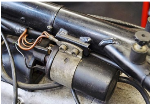
An Motorrädern, bei denen die Masse am Rahmen liegt, sind die MASSEANSCHLÜSSE besonders sorgsam zu prüfen
