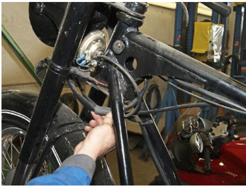
KABELBRÜCHE innerhalb des Kabelstrangs sind schwer zu lokalisieren. Biegen und Ziehen hilft, die Schadstelle einzugrenzen
