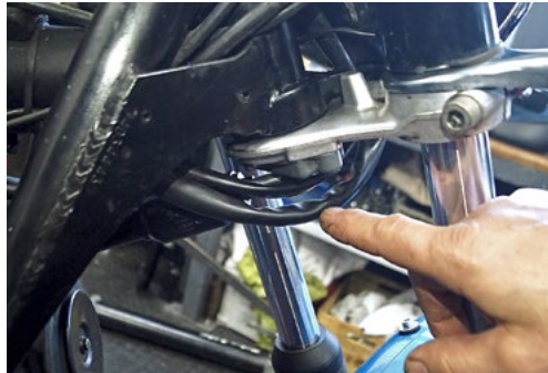
Der Kabelbaum am LENKKOPF muss die Lenkbewegung ohne Dehnung oder Quetschung in beide Richtungen mitmachen
