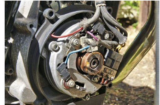
Die Bezeichnung D- findet man nur auf Gleichspannungs- oder Wechselspannungsgeneratoren mit EXTERNEM REGLER
