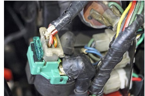
Das Kabel hat am STECKER GESCHMORT . Ist der Verbraucher defekt oder ist der Übergangswiderstand zu hoch?
