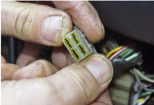
Auch die KLEMMKRAFT DER STECKVERBINDER innerhalb des Steckers lässt nach mehrmaligem Öffnen stark nach
