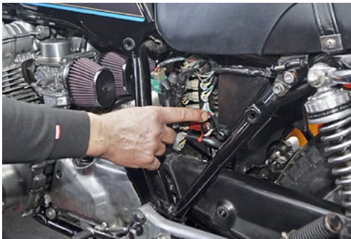
Alle Stecker liegen hier im Bereich des SPRITZWASSERS vom Hinterrad. Kurzschlüsse sind nur eine Frage der Zeit
