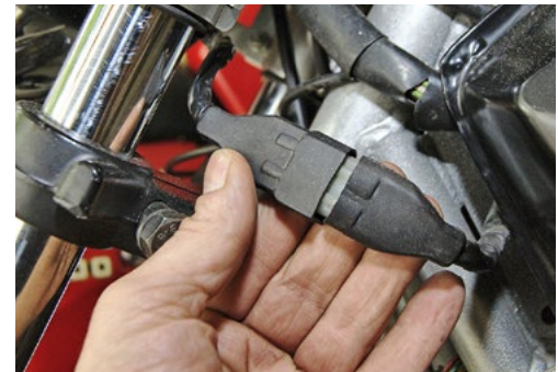
Die GUMMIISOLIERUNGEN der Steckverbindungen dürfen nicht gebrochen oder spröde sein
