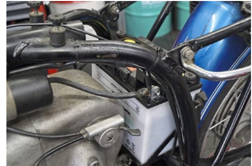
Im Bereich der Batterie kann der Kabelbaum wegen der Batteriesäure an OXIDATION leiden
