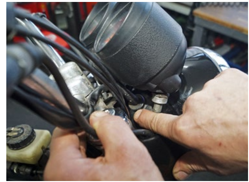
Saubere Lösung: Diese GUMMIFÜHRUNG schützt das Kabel vorm Durchscheuern an der Instrumentendurchführung
