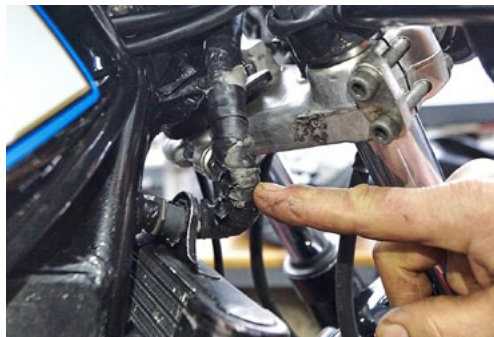
Je dicker der Kabelstrang im BEREICH DES LENKKOPFS , desto höher ist das Risiko, dass er bricht
