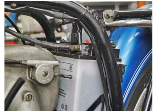
Idealerweise verbindet man die Kabel zum Durchmessen des Kabelbaums mit KROKODILKLEMMEN
