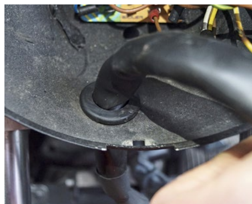
Bei Durchführungen durch Lampentöpfe oder Kotflügel muss der Kabelbaum mit GUMMIEINSÄTZEN geschützt werden
