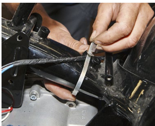
Zum Erhalt der originalen Optik können auch METALLBINDER zur Befestigung des Kabelbaums verwendet werden
