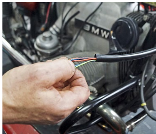
KABELTÜLLEN , wie sie oft von den damaligen Herstellern verwendet wurden, gibt es heute noch als Meterware zu kaufen
