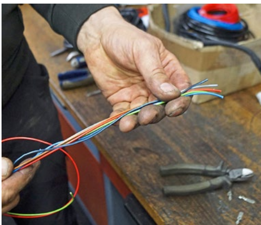
Beim Nachbau eines Kabelbaums müssen Kabelfarben und -querschnitte genau den ORIGINALVORGABEN entsprechen
