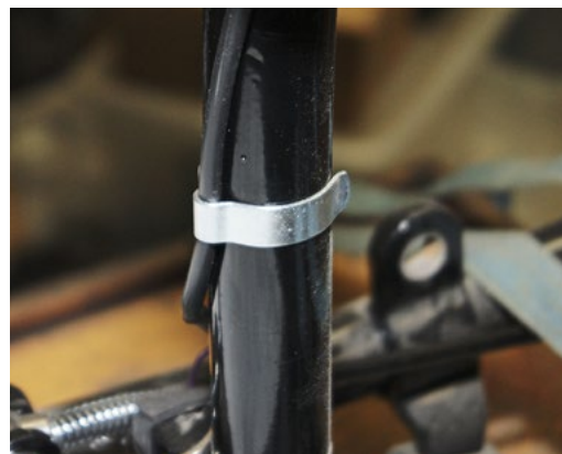
Für die Befestigung des Kabelbaums am Rahmen gibt es SPEZIELLE KLAMMERN aus Metall
