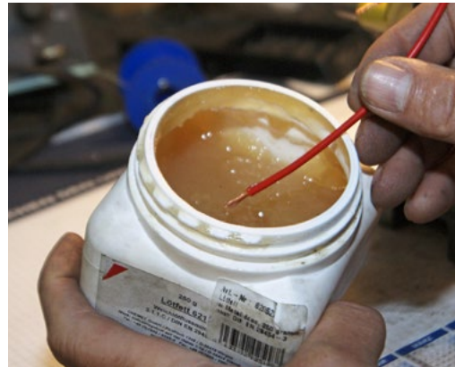
Damit das Lötzinn besser fließt, sollte das Kabelende unbedingt mit LÖTFETT bestrichen werden
