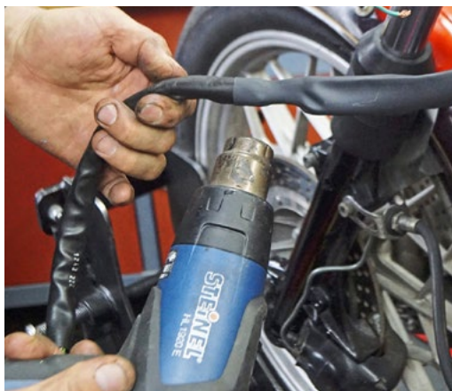
SCHRUMPFSCHLÄUCHE sind ideal, um einzelne Kabel zusammenzufassen. Sie bieten einen guten mechanischen Schutz
